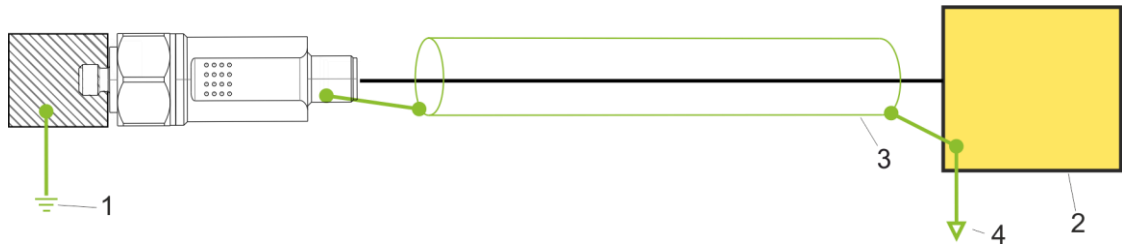
Şekil 4: Standart Topraklama konsepti
